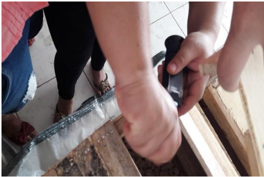
Medición de los grados Brix al inicio de la fermentación mediante el refractómetro.
