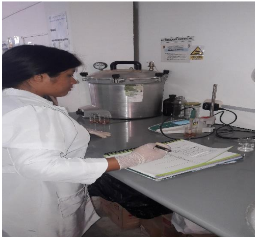
Medición del pH mediante el pH-metro digital
