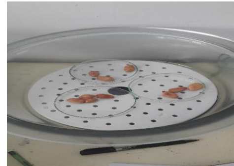
Determinación de la humedad mediante estufa.
