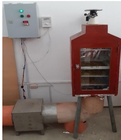
Figura 1. Secador de bandejas por aire forzado.
