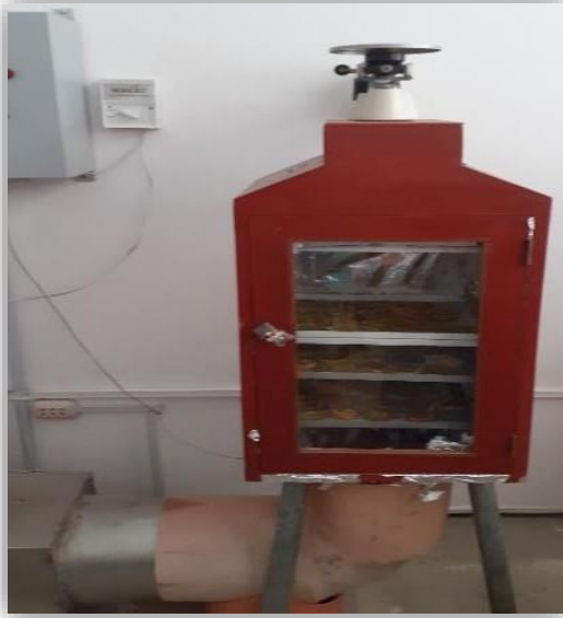
Equipo de deshidratación con aire forzado
