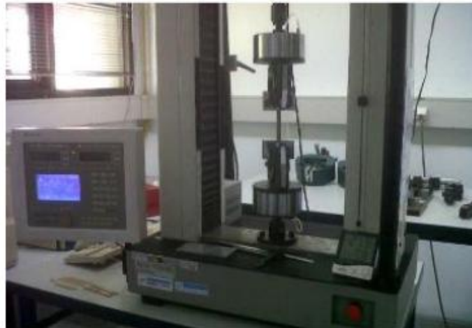
Figura 11. Prueba de resistencia a la tracción máxima mediante UTM
