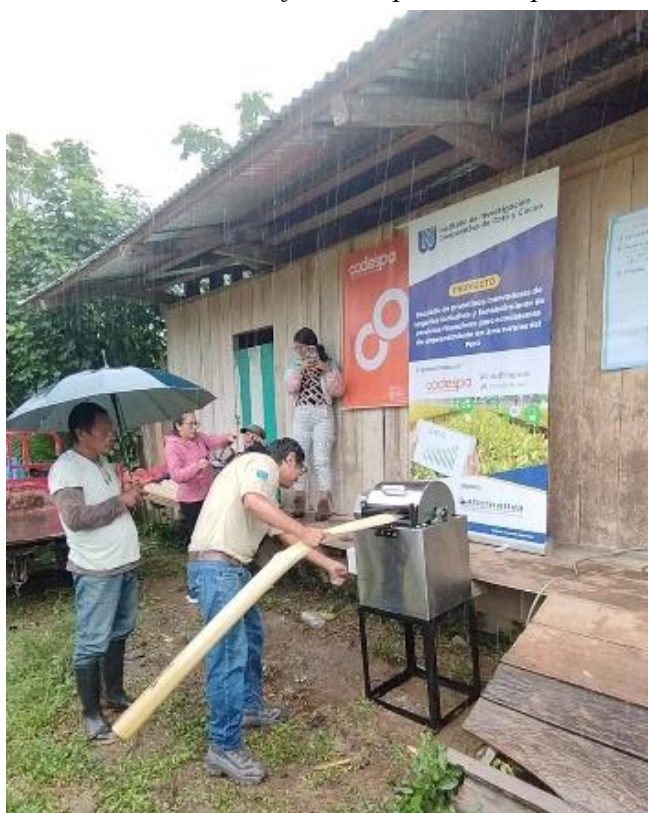
Figura 1. Máquina extractora de biofibra de plátano implementada en la comunidad.
