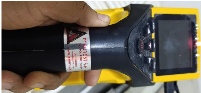
Figura 1 Detector de materiales (acero estructural)
