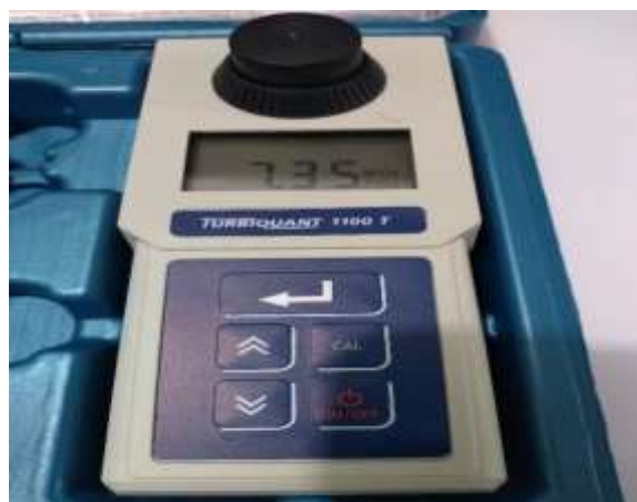
Figura 43. Lectura de turbidez en el equipo turbidímetro.
