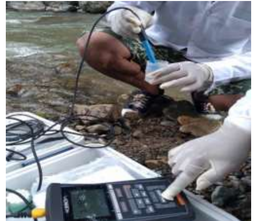
Figura 37. Inicio de la medición de los parámetros de campo.
