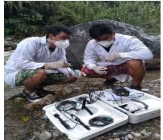
Figura 35. Verificación de los sensores del multiparámetro.
