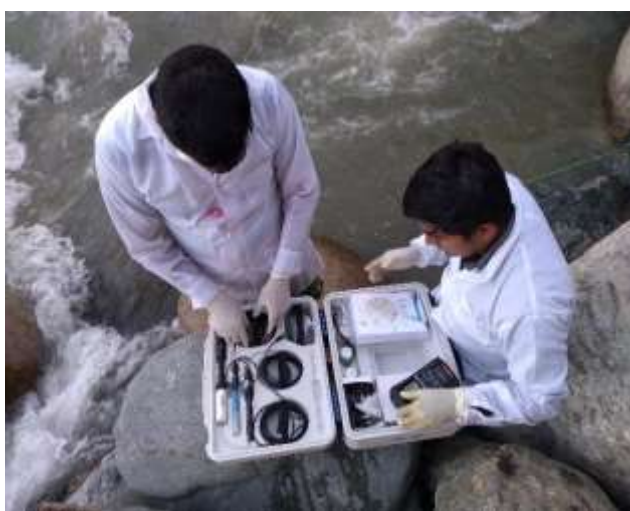
Figura 44. Equipo de investigación haciendo uso del multiparámetro para determinar parámetros in situ.
