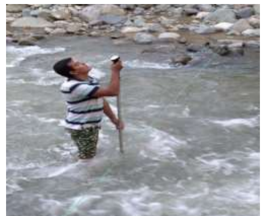
Figura 39. Medición de la velocidad con el correntómetro.
