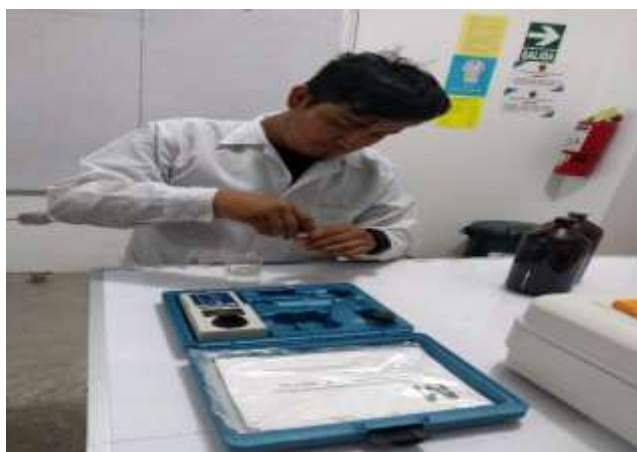
Figura 42. Calibración de equipo turbidímetro.
