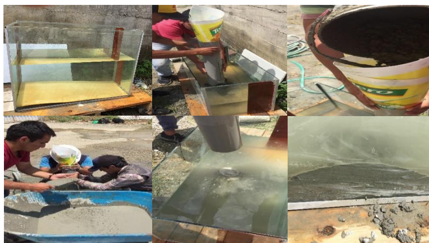
Figura 72. Proceso de vaciado – método tremie (CAD).
