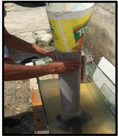
CAJA DE VIDRIO Y SELLADO DEL TUBO ANTES DE LA COLOCACION DE CONCRETO
