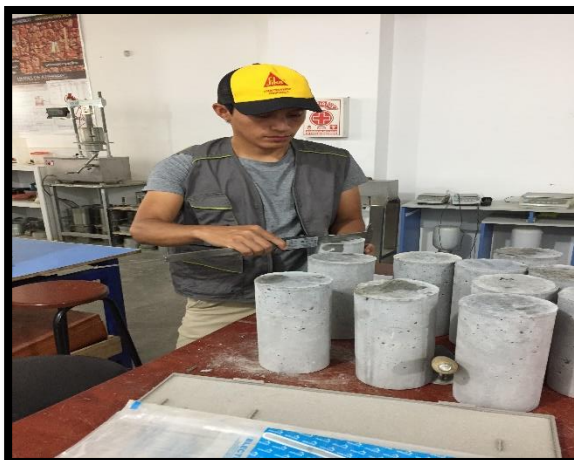
TOMA DE DIÁMETROS Y RUPTURA DE ESPÉCIMENES
