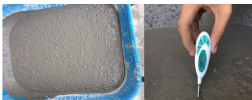
Figura 40. Temperatura del concreto.
