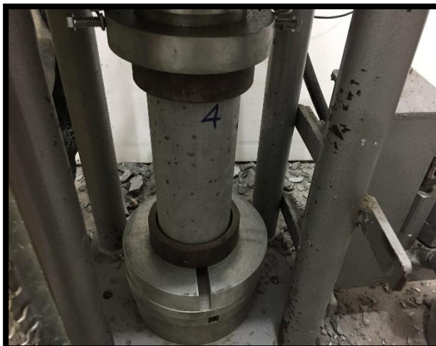
FALLA DEL ESPÉCIMEN SOMETIDO A ESFUERZO DE COMPRESIÓN
