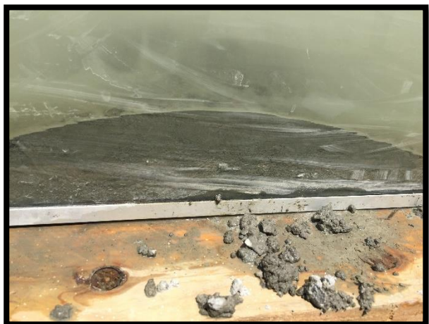
RETIRO DEL TUBO Y COMPORTAMIENTO DE LA MEZCLA EN PRESENCIA DE AGUA
