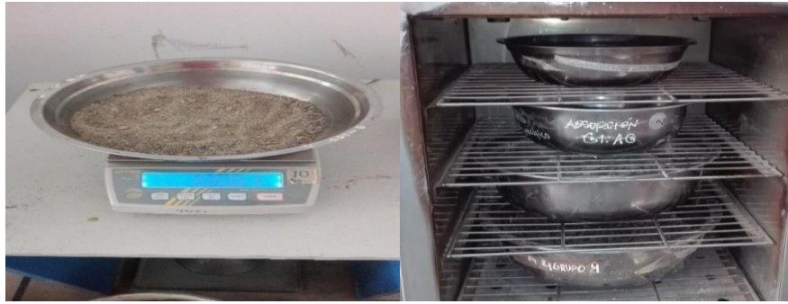
Figura 10. Muestra de agregado fino para determinar el contenido de humedad.
