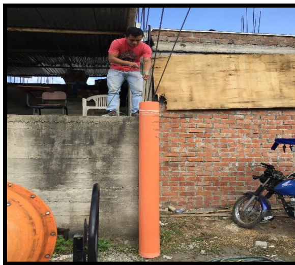
INMERSIÓN DE LA MUESTRA EN EL TUBO AFORADO CON AGUA
