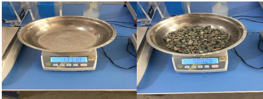
Figura 11. Muestra de agregado grueso para determinar el contenido de humedad.
