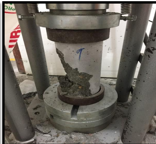
FALLA DEL ESPÉCIMEN SOMETIDO A ESFUERZO DE COMPRESIÓN
