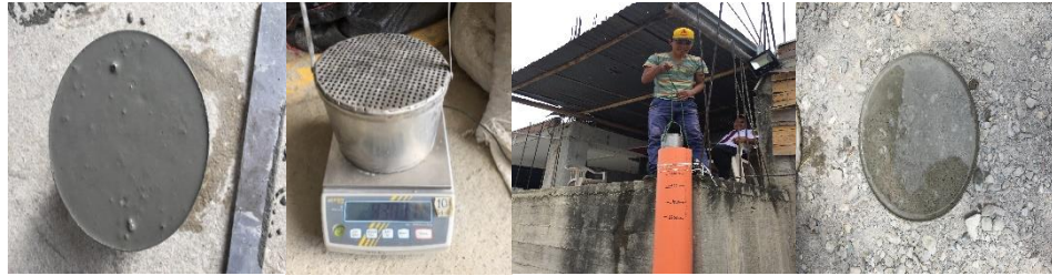
Figura 49. Ensayo para la evaluación de pérdida de finos.
