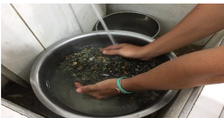
Figura 14. Lavado del agregado grueso por la malla N° 200.
