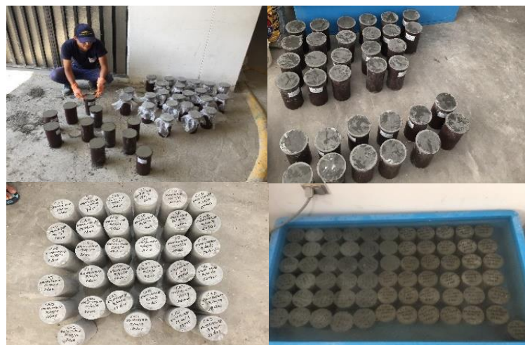
Figura 53. Elaboración y curado de especímenes.
