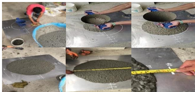
Figura 42. Ensayo de Extensión de flujo.
