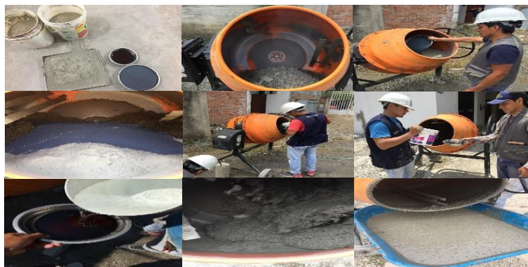
Figura 34. Proceso de elaboración de concreto antideslave (CAD).
