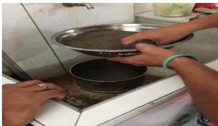
Figura 13. Lavado del agregado fino por la malla N° 200.
