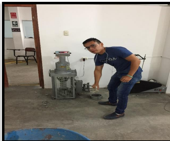
TOMA DE DIÁMETROS Y RUPTURA DE ESPÉCIMENES
