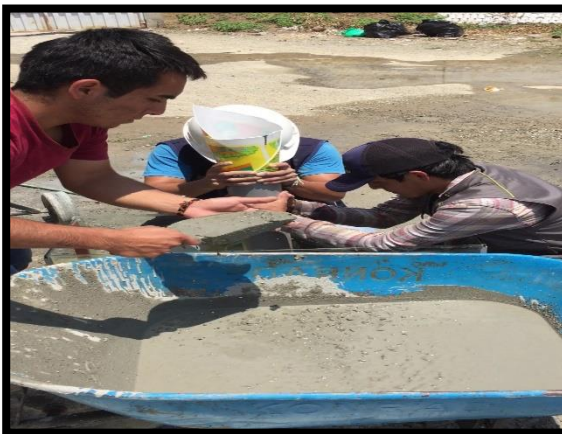
COLOCACIÓN DE CONCRETO A TRAVÉS DEL TUBO
