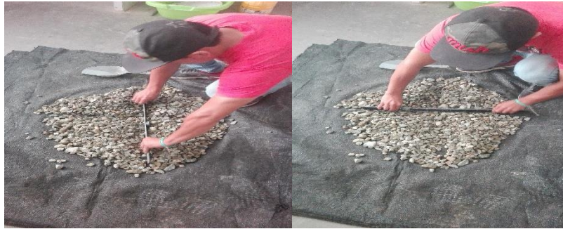
Figura 8. Cuarteo del agregado grueso.
