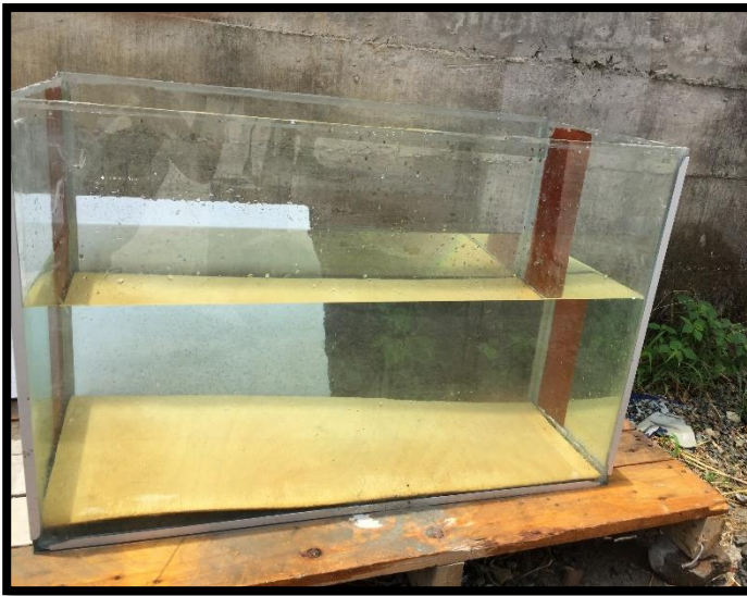
CAJA DE VIDRIO Y SELLADO DEL TUBO ANTES DE LA COLOCACION DE CONCRETO
