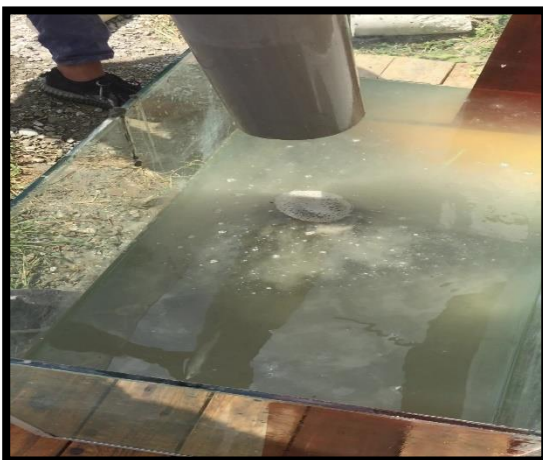
RETIRO DEL TUBO Y COMPORTAMIENTO DE LA MEZCLA EN PRESENCIA DE AGUA
