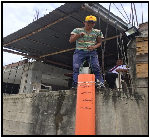
INMERSIÓN DE LA MUESTRA EN EL TUBO AFORADO CON AGUA
