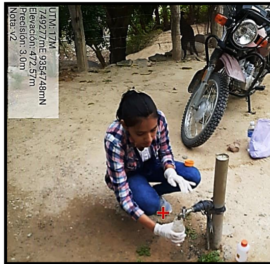
Foto 06: Toma de muestras de agua en el vidrio esterilizado del grifo domiciliario N°2.
