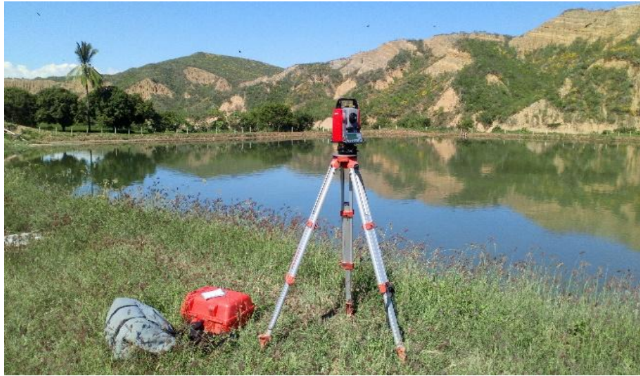
Figura N° 24. Levantamiento topográfico de PTAR de Jaén.
