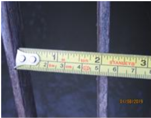
Imagen N° 4. Ancho de Criba para Gruesos sin Control de Finos
