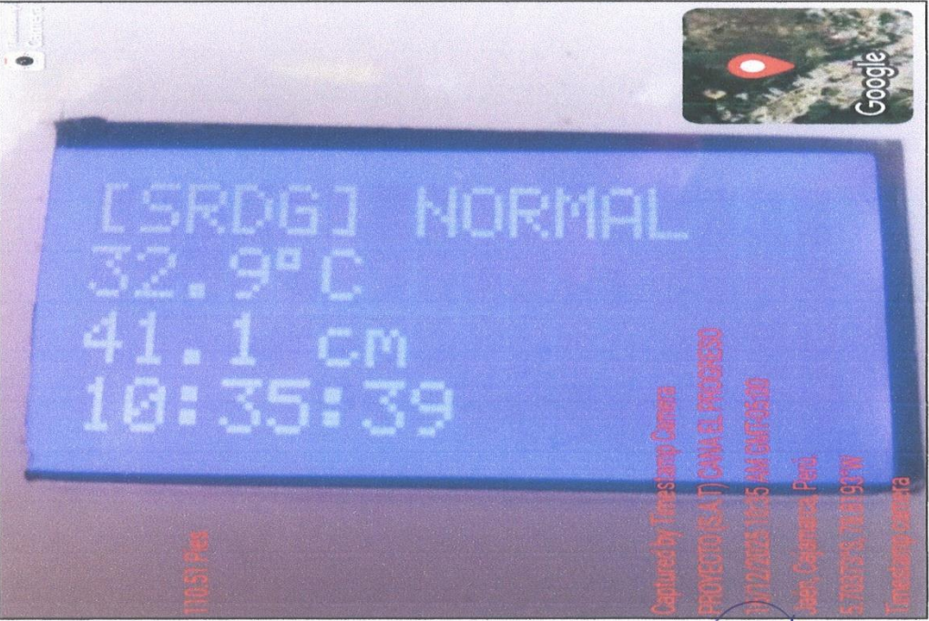
Imagen 04: Se muestra la visualización de texto en pantalla LCD del prototipo, donde especifica un nivel normal a una distancia del agua de 41.1 cm respecto al borde del canal (40 cm nivel normal, según umbral establecido).
