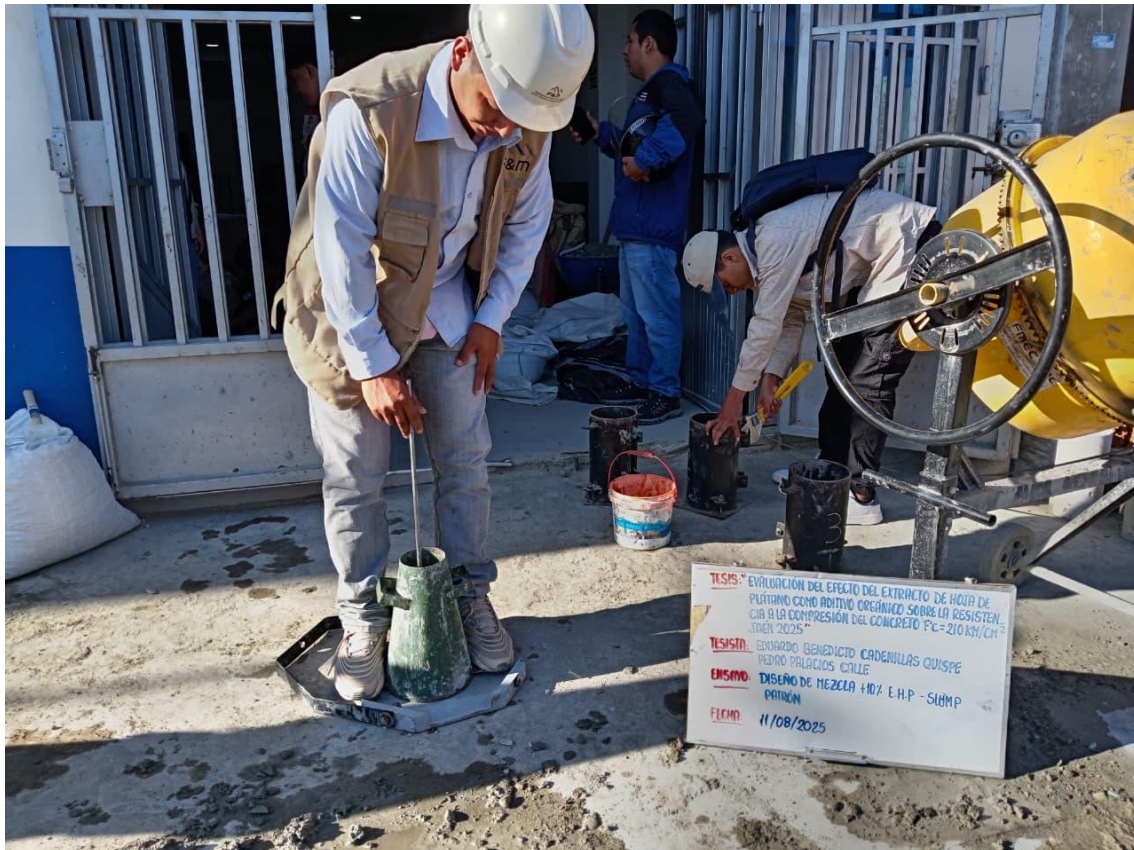
Figura 5. Ensayo de revenimiento (Slump Test)
