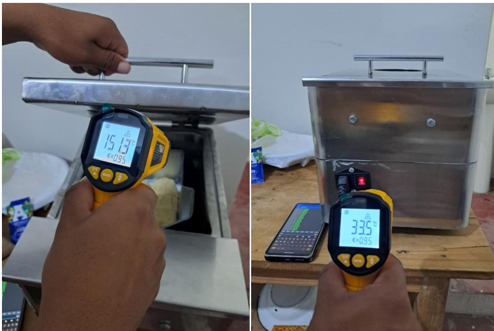
Cocción de pan convencional a 150 °C y medición de temperatura
