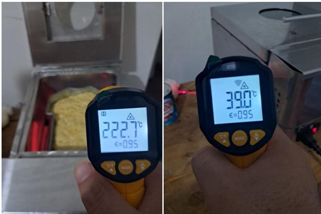
Cocción de pan de molde a 220 °C y medición de temperatura
