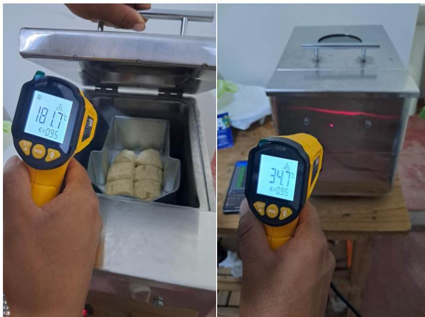
Cocción de pan convencional a 180\text{ }^{\circ}\text{C} y medición de temperatura
